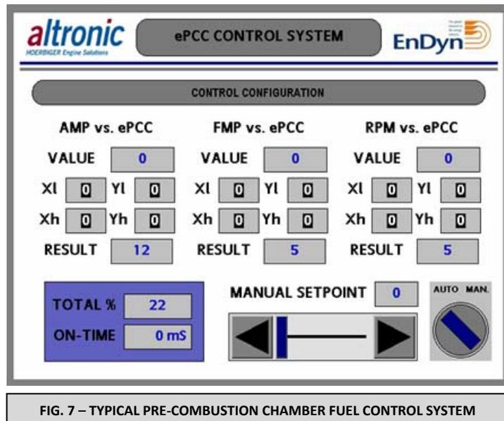
FIG. 7 – TYPICAL PRE-COMBUSTION CHAMBER FUEL CONTROL SYSTEM
